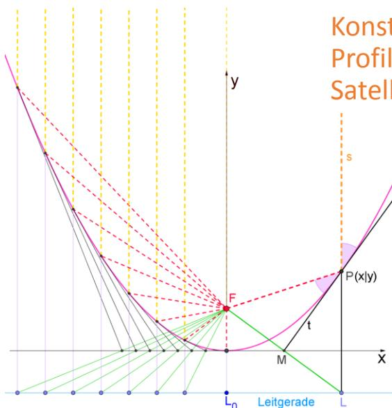
**Konstruktionsaufgabe: bestimme das Profil eines Scheinwerfers oder einer Satellitenschüssel.**
